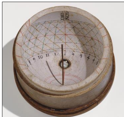
Fig. 4. Een draagbaar zonnwijzertje voor Baselse, Babylonische en Italiaanse uren, met een ingebouwd kompasje. (Foto: Historisches Museum Basel.)
