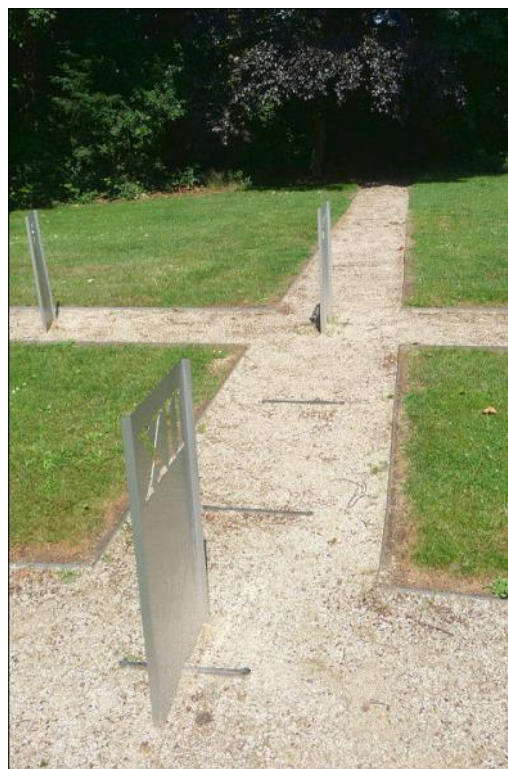
Fig. 2. De middaglijn met datumstreepjes per dierenriemaand
