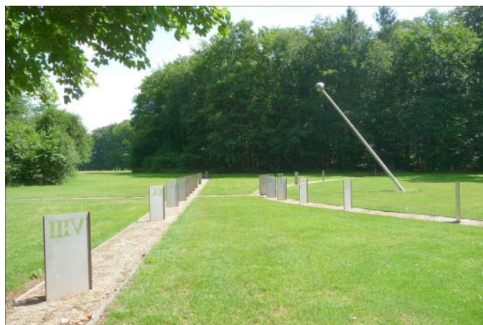
Fig. 1. De zonnewijzer, met poolstijl, equinoxlijn (links) en datumlijn voor het zomersolstitium, beide met uurpunten.
