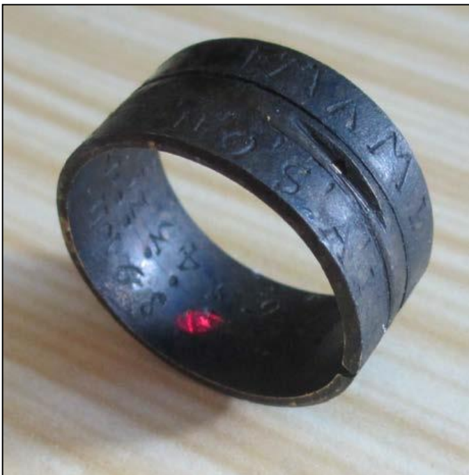
Afbeelding 5.: het aflezen van de lichtbundel geïllustreerd met behulp van een laserpointer (foto: auteur).
