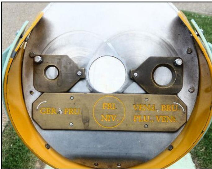
Fig. 16. De gnomon van de meridiaanlijn. De opening in het midden is voor de winter ( Frimaire, Nivose ), het kleine diafragma links voor lente en zomer ( Germinal t/m Fructidor ), het rechter voor de rest van het jaar.
