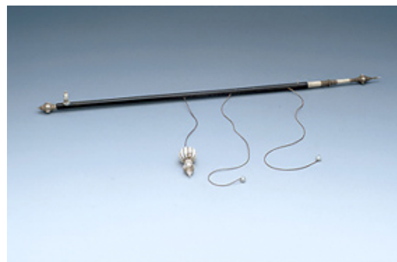
Reconstructie door Henri Michel van het lineair astrolabium van Al-Tusi
