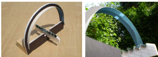
Figuur 7: opstelling van een hoepelzonnewijzer, gekanteld tot een verticale boog. De gespiegelde poolstijl is opgebouwd uit een aantal spiegeltjes.
