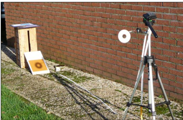
Fig. 3 (links). Geïmproviseerde opstelling om de schaduw van een ringvormige gnomon op te vangen, waarna er een foto van genomen werd.
