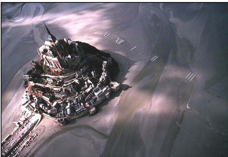
Fig. 2. De Mont St. Michel vanuit de lucht. De cijfers zijn opgebouwd uit metalen spiegels van 1 \text{ m}^2 . Uurcijfers van IX tot III en halfuurspunten liggen op de equinoxlijn. De schaduw van de torenspits wijst hier bijna 2 uur. Bron: [2]
