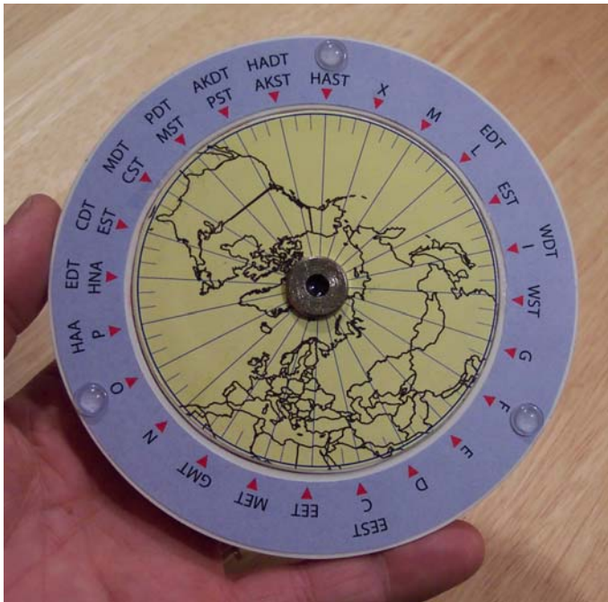
Figuur 10: de achterkant van de zonnewijzer met mogelijkheid tot instellen van de lengtecorrectie met behulp van een wereldkaart en de tijdzones
