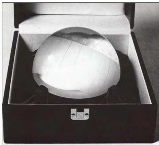
Fig. 11. Reflectiezonnewijzer op kristallen bol, die geleverd werd in een met fluweel bekleed kistje. Uit [4].
