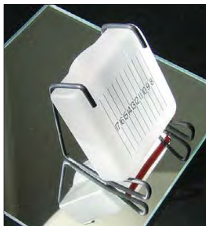
Fig. 2. Polaire opstelling op een spiegel, om de schaalverdeling in het zicht te houden. De gnomon is op het spiegelbeeld van de hemelpool gericht.
