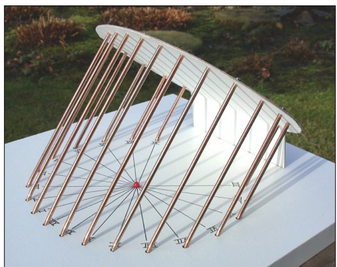
Fig. 2. Het model van fig. 1, afgewerkt met een afdekplaat. Het afleespunt is gemarkeerd met een gekleurde speldenknop. Hier is het ca. 11.40 uur zonnetijd. En het is herfst of winter, want de zon schijnt onder tegen het dak, dat in het equatoriale vlak ligt.
