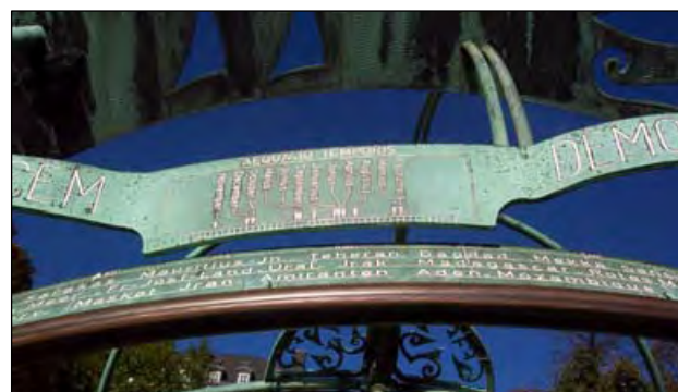
Fig. 9.a. De monumentale armillairsfeer van Lothar Loske in Frankfurt na de herplaatsing. De ring even onder het midden is draaibaar en draagt ruim 200 plaatsnamen. b. Een deel van de wereldtijdschaal. De tijdsvereffening wordt ingesteld langs de maandenschaal in het midden. Daarboven de dubbele boog voor de precieze bepaling van het lokale middaguur. Foto's: Reinhold Kriegler.
