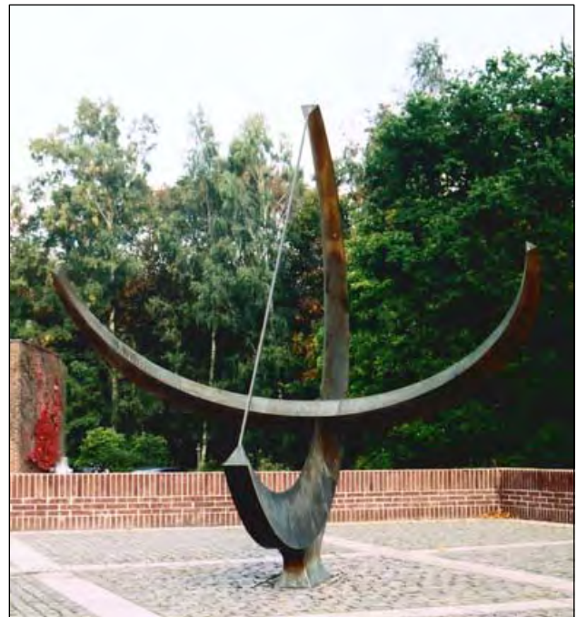
Fig. 11. De prachtige equatoriale zonnewijzer van Henri Moore bij het voormalige opleidingscentrum van IBM in La Hulpe. De diameter is 3,6 meter; de schaal loopt van 6 tot 6 (18) uur, onderverdeeld per 5 minuten. De poolstijl is 24 mm dik, toereikend voor een duidelijke schaduw op de urenchaal.
