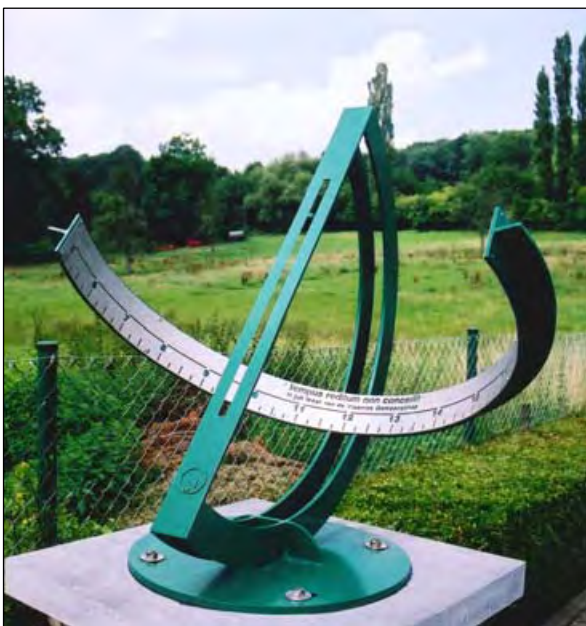
Fig. 10. De equatoriale zonnewijzer van Willy Leenders in Sint-Martens-Voeren (B). De schaal loopt van 5 tot 19 uur zonnetijd. Eenzelfde zonnewijzer staat er in Hasselt (B).
