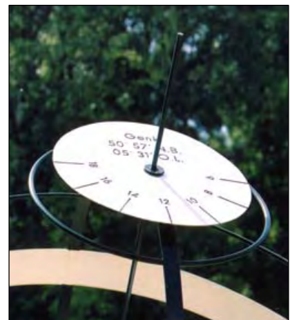
Fig. 2. Het equatoriale zonnewijzertje aan de noordpool.
