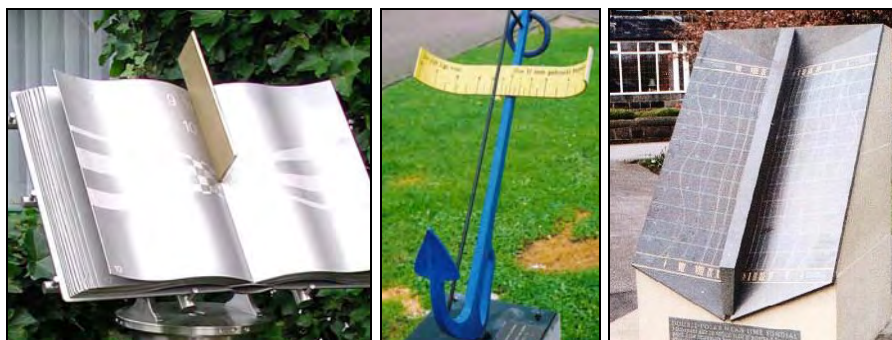
Fig. 7. Door de uiteinden van de wijzerplaat naar voren te brengen wordt de tijdschaal gecomprimeerd en het bereik vergroot. a. ontwerp en foto Mike van Grieken (Antwerpen), b. Rupelmonde, ontwerp Julien Lyssens, c. Otley (bij Leeds, Engeland), ontwerp Chris Daniel, foto John Davis.
