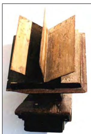
Fig. 8a. Boekzonnewijzer in het Maarten van Rossum-museum in Zaltbommel. De uren staan bovenaan de bladzijden vermeld. b. Equatoriale doorsnede door de rechter (oost) helft van het boek. De randen van de staande en liggende pagina's werpen hun schaduw op de schuine pagina en omgekeerd.
