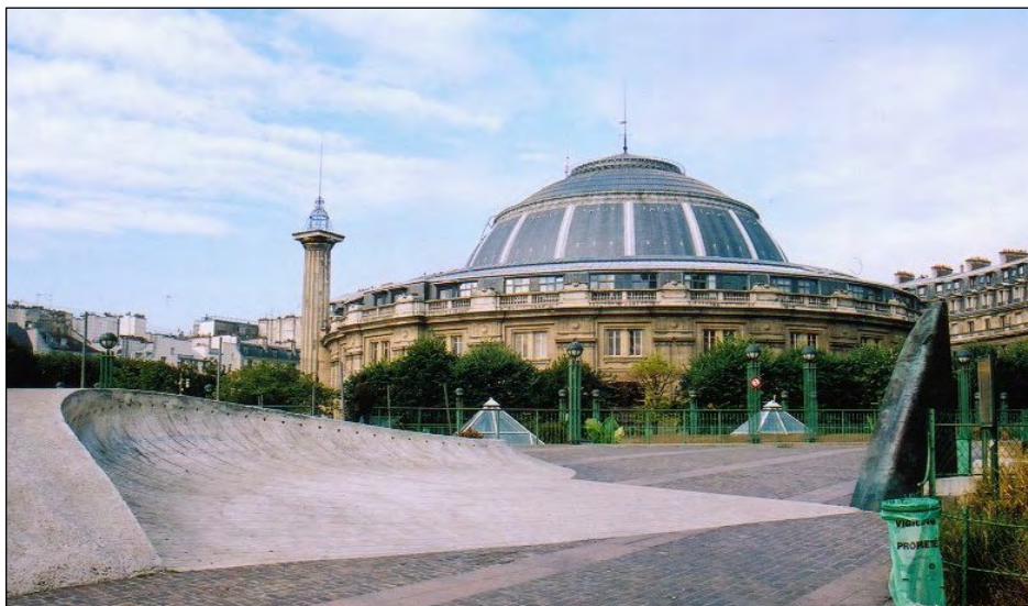
Fig. 12. De glasvezel-zonnewijzer in de Jardin des Halles in Parijs. Het zonlicht valt door gleuven in de monoliet rechts op glasvezels, die naar de kwartier-punten net onder de rand van de golf links lopen. Op de halfronde bank rechts van de monoliet staat o.a. een grafiek van de tijdsvereffening. Op de achtergrond de Beurs met de kolom van de Médicis, waaraan ooit de uurvlakzonnewijzer van Pingré zat [10].
