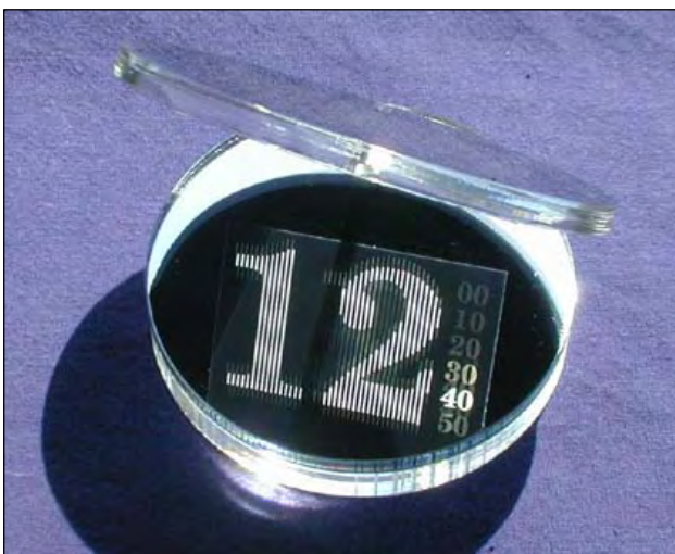
Fig. 9. De huiskamer-versie van de digitale zonnewijzer. Aflezing op enkele minuten nauwkeurig: het getal 40 licht sterker op dan 30; het is dus tussen 12.35 en 12.40 uur.
