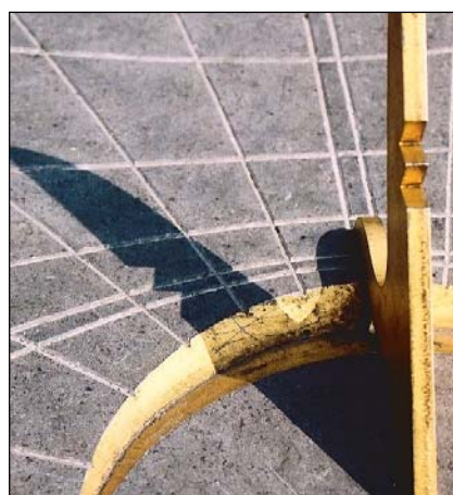
Fig. 2. Het puntje in de W-vormige inkeping wijst de datum. Het was hier 24 juli, een maand na het zomersolstictium. Let ook op de dubbele 12-uurs lijn.
