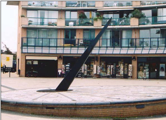
Fig. 9. Pleinzonnewijzer in het winkelcentrum Heksenwiel in Breda. De wijzerplaat helt 2^\circ naar het zuiden. De aanwijzing is in zomertijd. De berekening werd gedaan door Fer de Vries.
