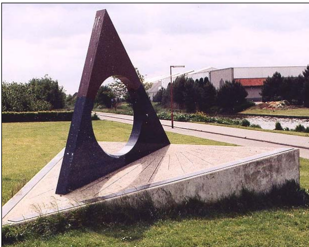
Fig. 10. Zonnewijzer van Thibaud Taudin Chabot in het Burgemeester Hoekstrapark in Zoetermeer. Gnomon en wijzerplaat zijn gelijkzijdige driehoeken. De wijzerplaat helt 8^\circ naar het noorden en heeft uurlijnen voor MET. In de zuidkant van de gnomon zit een gaatje, zodat op de ware middag een lichtvlekje op de binnenkant van de grote ronde opening valt, waarop een datumschaal aangebracht is.
