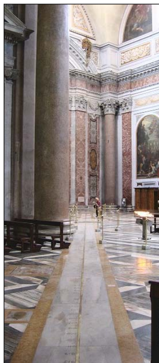
Fig. 5. a) De meridiaanlijn in de kerk Santa Maria degli Angeli, naar het zuiden gezien. De gnomon bevindt zich in het bronzen ornament net links van de hoek. b) De gnomon van dichtbij; let op de inkeping die in het timpaan is gemaakt om het zonlicht niet te blokkeren. Uit [5].
