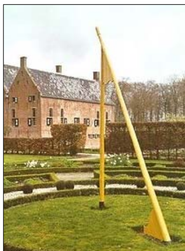
Fig. 7. Parkzonnwijzer in de tuin van de Menkemaborg in Uithuizen met ondersteunde poolstijl. De uurpunten worden gevormd door buxus-bolletjes, het 12-uurs punt heeft er twee.
