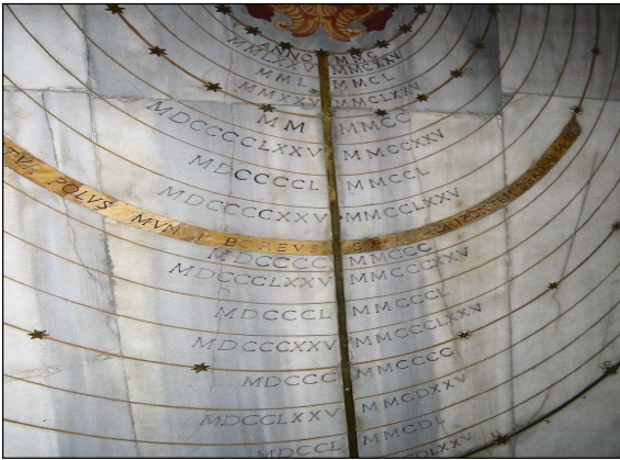
Fig. 6. De baan van de Poolster zoals door de noordelijke gnomon geprojecteerd, in stappen van 25 jaar. De binnenste ellips is voor het jaar 2100, wanneer de ster de hemelpool het dichtst nadert.
