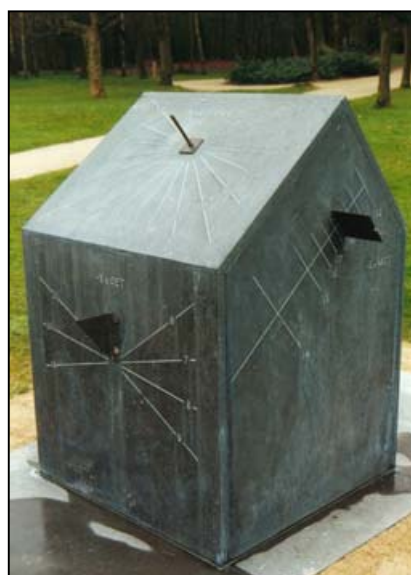
Fig. 1. De polyedrische zonnwijzer. a) links: vanuit het ZZO ziet men de polaire zonnwijzer, de verticale zuid- en oostwijzer en de horizontale zonnwijzer; b) rechts: vanuit het NW ziet men de vlakke equatoriale zonnwijzer en de verticale noord- en westwijzer.
