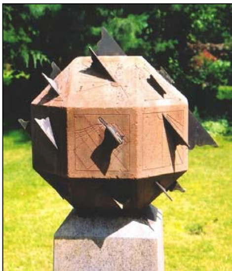
Fig. 9. Polyedrische zonnenuijzer in Horn (Limburg), waarschijnlijk afkomstig uit de Elzas. Op 25 van de 26 vlakken zijn zonnenuijzers aangebracht.
