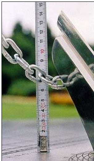
Fig. 10. Het laagste punt van de kettinglijn dient 70 mm boven het tafereel te liggen. Juli 2001 klopte dat weer.
