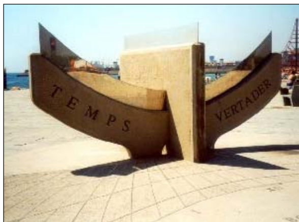
Fig. 7. Kruisdraad-zonnewijzer van Rafael Soler in het Olympisch Dorp in Barcelona. De horizontale gnomon loopt op 2 meter hoogte, de parabool heeft het laagste punt op 1 meter boven de grond. Bron: [6].
