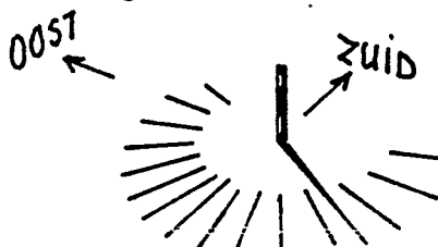
FIG 1. Verondersteld hierbij is dat de schaduw van het paaltje gelijkmatig rondgaat. En dit is niet het geval.
