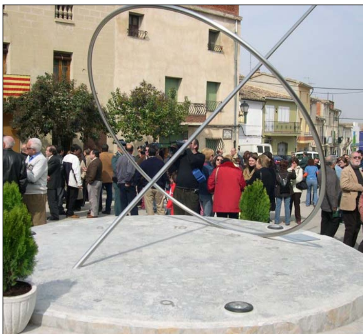
Fig. 7. De horizontale zonnwijzer van kunstenaar Andreu Alfaro in Otos (Spanje). De even uren zijn becijferd, de oneven alleen met een punt aangegeven. De equatoriale ring is alleen sculpturaal bedoeld. Aan de schaduw van de ring is te zien dat het enkele dagen voor de lente-equinox is. Foto: Conxita Bou.
