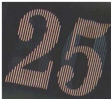
Fig. 4. Detail uit fig. 1. Elk cijfer wordt door meer dan 20 verticale streepjes gevormd. Tussen elk tweetal streepjes zitten nog 11 andere. Je ziet hier de 0 van 3.30 uur al door de 5 schemeren.
