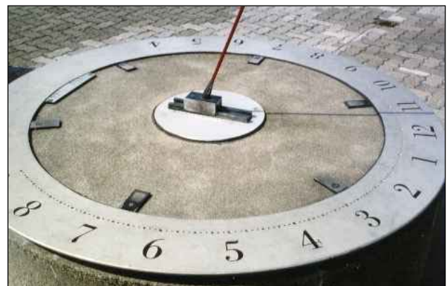
Fig. 10. Foster-Lambert zonnwijzer in Muttenz (bij Basel, Zwitserland). De diameter is 1 meter. De uurschaal is homogeen ( 15^\circ per uur). Door hem te draaien kunnen lengtecorrectie, tijdsvereffening en zomertijd in rekening gebracht worden. Bron: [5].
