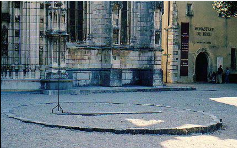
Fig. 6. De oudste analemmatische zonnwijzer, voor de kathedraal van Brou (Bourg-en-Bresse, Frankrijk) ligt hier nog in de ochtendschaduw. De lange as van de ellips is een royale 11.5 m. De schaduwgever, een staaf van 1.9 m hoog op een
