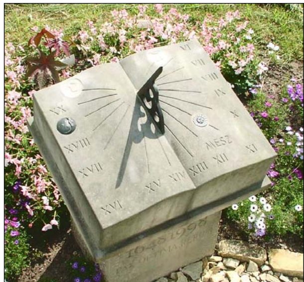
Fig. 11. Deze boekzonnewijzer van Albert Jan Jansen uit Osnabrück helt ca. 13^\circ naar het noorden, om vanuit huis gemakkelijk afleesbaar te zijn. De aanwijzing is in zomertijd. Op de 11-uur lijn is een zonnetje verwerkt, en bij 19 uur een wassende maan, want in die gedaante zie je hem 's avonds.
