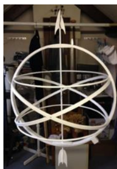
Fig. 3 De zonnwijzer ontdaan van roest en verf.
