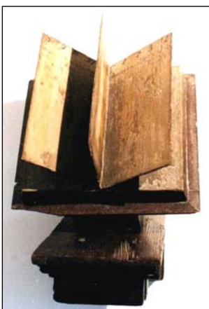
Fig. 8a. Boekzonnwijzer in het Maarten van Rossum-museum in Zaltbommel. De uren staan bovenaan de bladzijden vermeld. b. Equatoriale doorsnede door de rechter (oost) helft van het boek. De randen van de staande en liggende pagina's werpen hun schaduw op de schuine pagina en omgekeerd.
